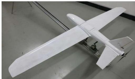
自主设计的复合材料固定翼无人机
