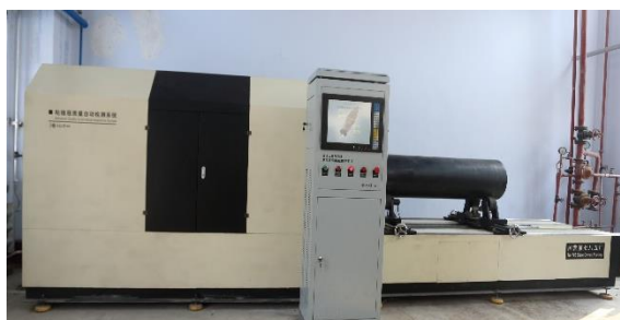
固体火箭发动机内涂层厚度非接触测量技术
