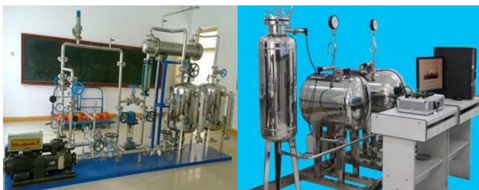
过程装备拆装系统 压力容器性能实验台
